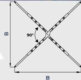
Lastaufnahmemittel zum Anschlagen von Lasten, bei denen bis zu 4 Anschlagpunkte uber eine gewisse Lange und Breite verteilt angeordnet werden mussen.
